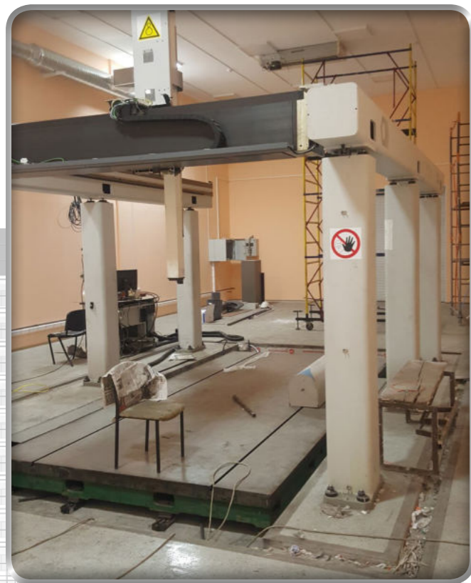
Проектирование, строительство, устройство высокоточных фундаментов, монтаж и подключение измерительной машины Alpha image 255015/205 по адресу: Москва, ул. Автозаводская, дом 23, стр. 82. Застройщик ООО «ААТ»
